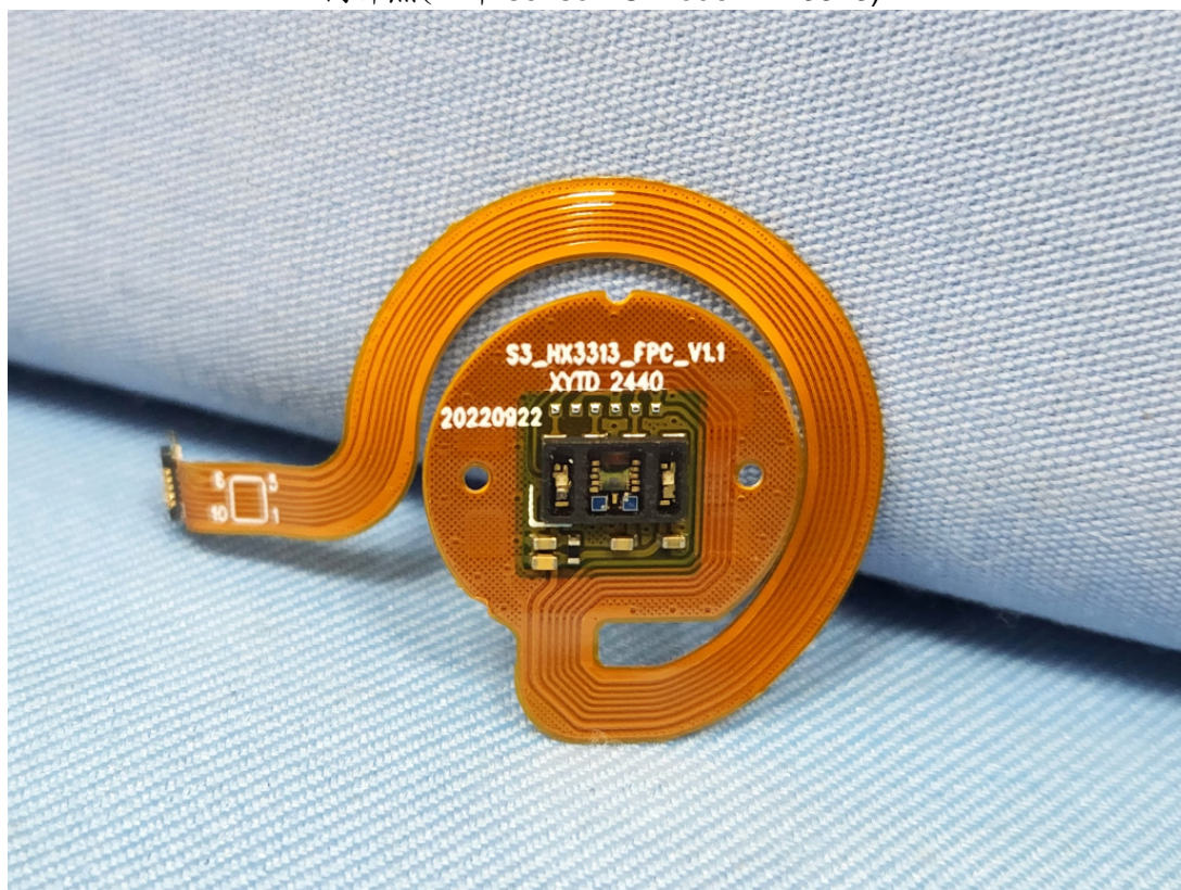
內部照(心率 sensor IC model: HX3313)
